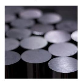
MP159 ist eine Legierung auf Nickel-Kobalt-Basis mit den gleichen Eigenschaften wie MP35N. Die Legierung MP159 ist ein ultrahochfestes Material mit guter Zähigkeit, Duktilität und ausgezeichneter Korrosionsbeständigkeit, das durch Verstärkung und Alterung eine Endzugzahl von mehr als 1830 MPa erreicht.
